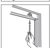
②タッピンネジで固定します。 注) 上枠が変形するまでタッピンネジを締めないでくだ
