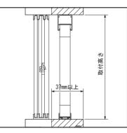
1. 取付位置の再確認 網戸の開閉に支障のないように取付位置を決めます。 ①取付枠及び床に段差がなく、幅37mm以上の取付幅があ
