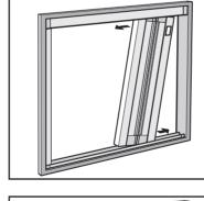
②各々収納枠をタッピンネジで固定します。(上図)こ の時、片側の網戸本体が倒れないようにテープ等で仮止 めし取り付けます。
