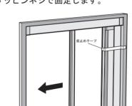
④仮止めテープをはずし、網戸を20~30cmぐらい閉め て、収納枠をタッピンネジで固定します。
