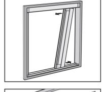
③収納枠が倒れないようにテープ等で仮止めし、戸当り 枠をタッピンネジで固定します。
