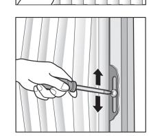
③ワイヤーを調整するネジは収納枠についています。ド ライバーを使用し、ネジを少しゆるめて調整方向に動か します。(調整方向は下図のワイヤー配線図を参考) ④調整後はネジを締め付け固定します。
