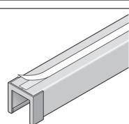
①上枠に仮止め用両面テープを貼付し、両面テープの剥 離紙をはがします。
