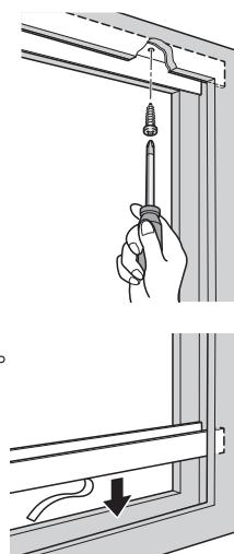
②下枠に貼付された両面テープの剥離紙をはがし、取り付け部に設置します。
